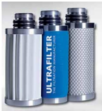
■ Секрет этого невероятного повышения эффективности заключается в плиссировании фильтровального холста. При этом основная часть фильтрующего элемента, фильтровальный холст, многократно складывается машинным способом. Таким образом, для проходящего воздуха или газа создана фильтрующая поверхность, которая на
