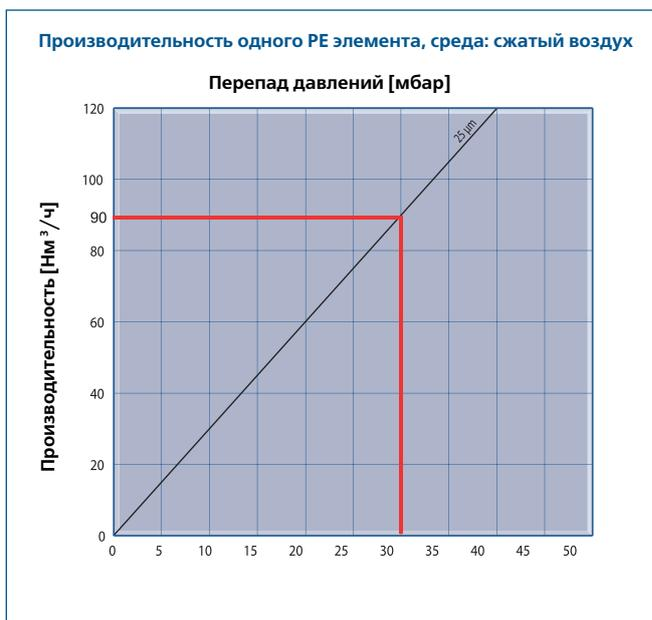
Данный график демонстрирует производительность 10/30 фильтрующего элемента в обычных условиях работы (1 бар (абс); 20 °С; F = 70%)
